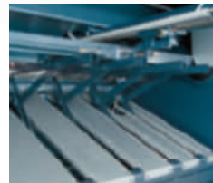
Пневматическая система поддержки листа
