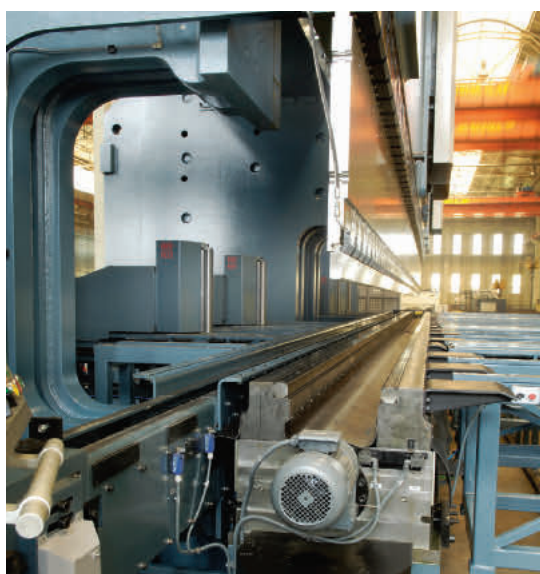
Моторизованная система регулировки нижнего инструмента. Раздвижная матрица.
