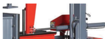
Гидравлические зажимные тиски с регулировкой давления
