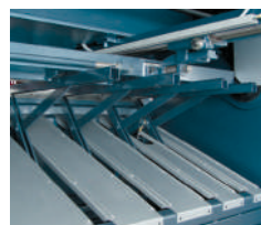
Пневматическая система поддержки листа
