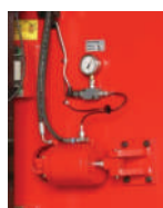
Гидравлическая регулировка полотна
